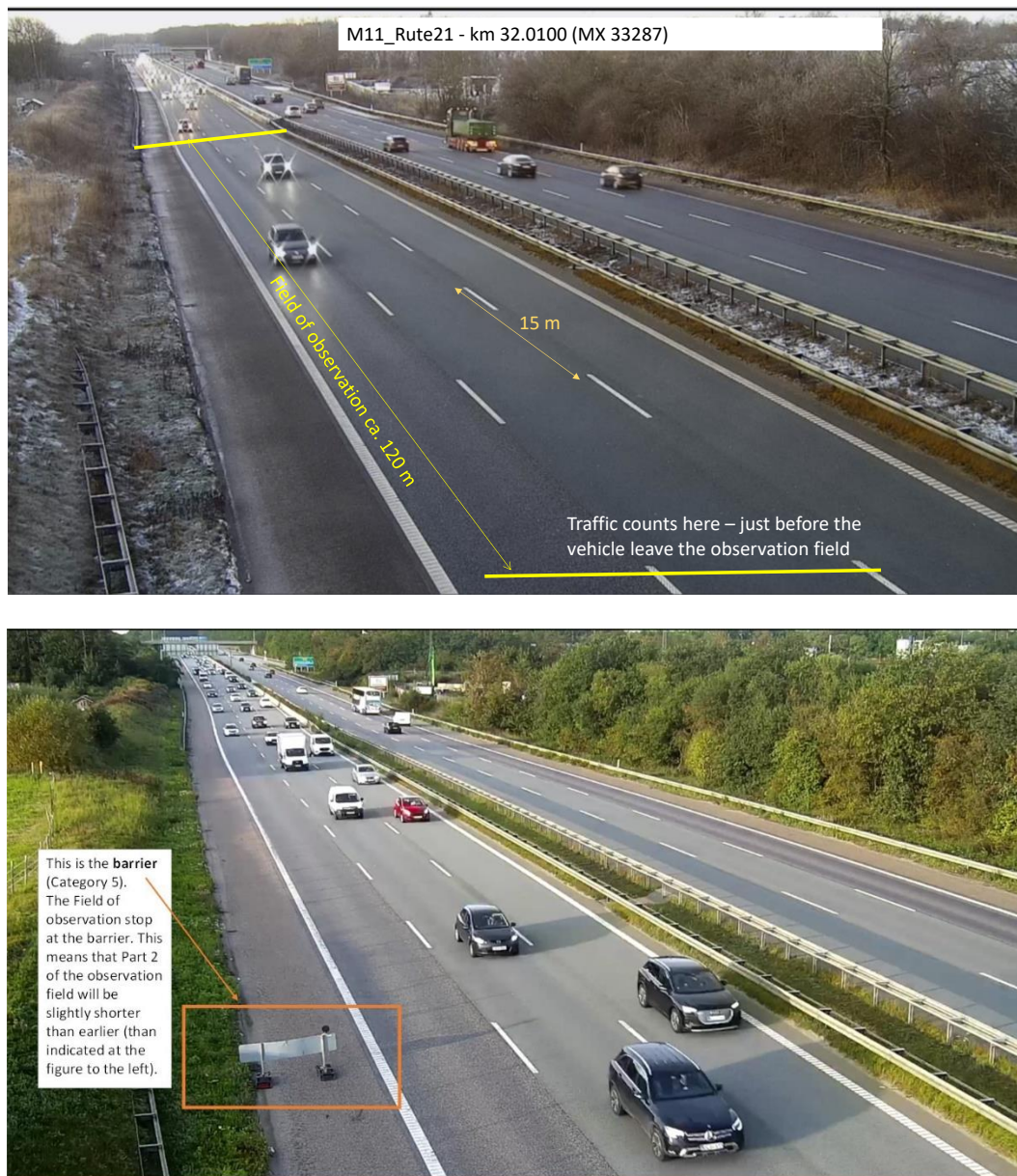
Figur 1. Lige strækning M11 - Rute 21, km 32,0100. Øverst: Uden spærrebom i nødspor. Nederst: Med spærrebom i nødspor. Observationsfeltets "startpunkt" bagest i billedet er det samme i begge perioder, mens observationsfeltets "slutpunkt" ender ud for spærrebommen i perioden med spærrebom i nødspor.
